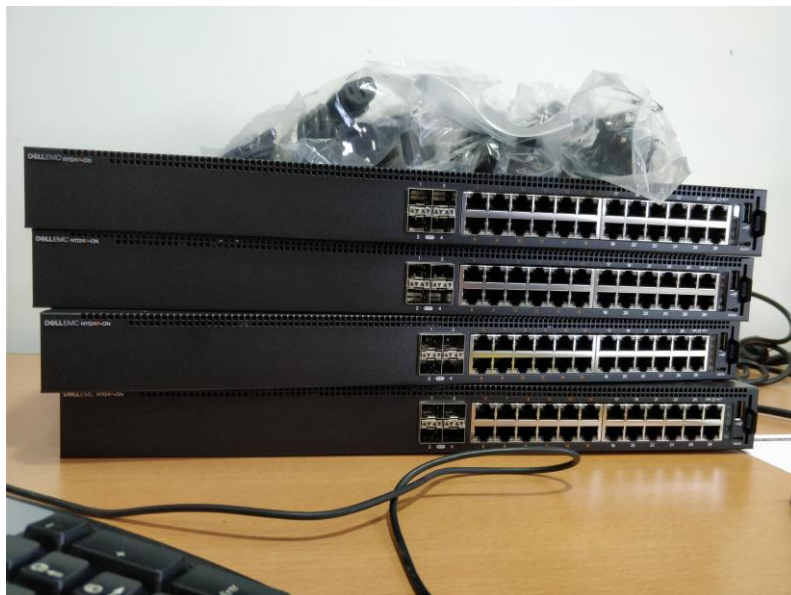
Les commutateur mis en places sont des Dell de la série N1124P-ON
